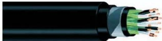
**ИНСТРУМЕНТАЛЬНЫЙ КАБЕЛЬ 300-500В, VO102VMV (ПВХ /ИЗОЛ. / ПВХ / CWSA / ПВХ)**
